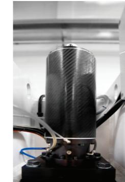
打击头除了能够提供比液压冲头更大的压力以外，它的施压时间、速度、行程和这些参数的重复精度完全变得精准可控。
